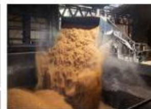
・ 製鉄保温材として加工している様子
