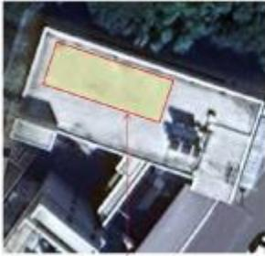
予定設置パネル数：36枚 20kwの設置容量
