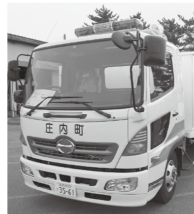
新規導入された排水ポンプ車
