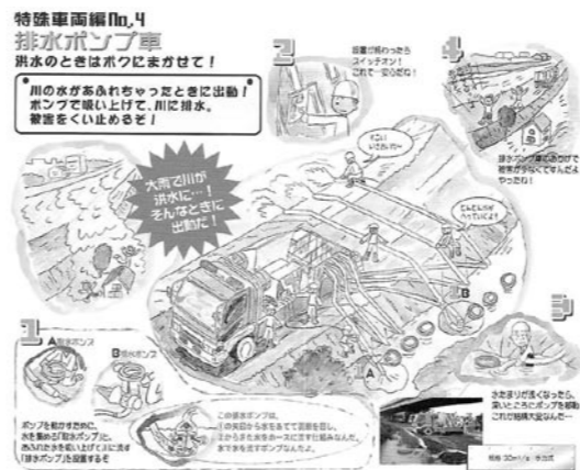
期待される排水ポンプ車の活用（高崎河川国道事務所 出展）
